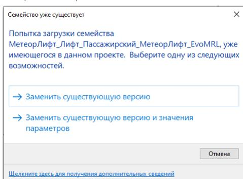
После загрузки семейства в проект в Диспетчере проекта в разделе «Семейства» в соответствующей категории появляется список доступных типоразмеров. Каждый типоразмер характеризуется грузоподъемностью лифта и размерами кабины. Пользователь определяет необходимый тип лифта в соответствии с требованиями к проектируемому зданию.
