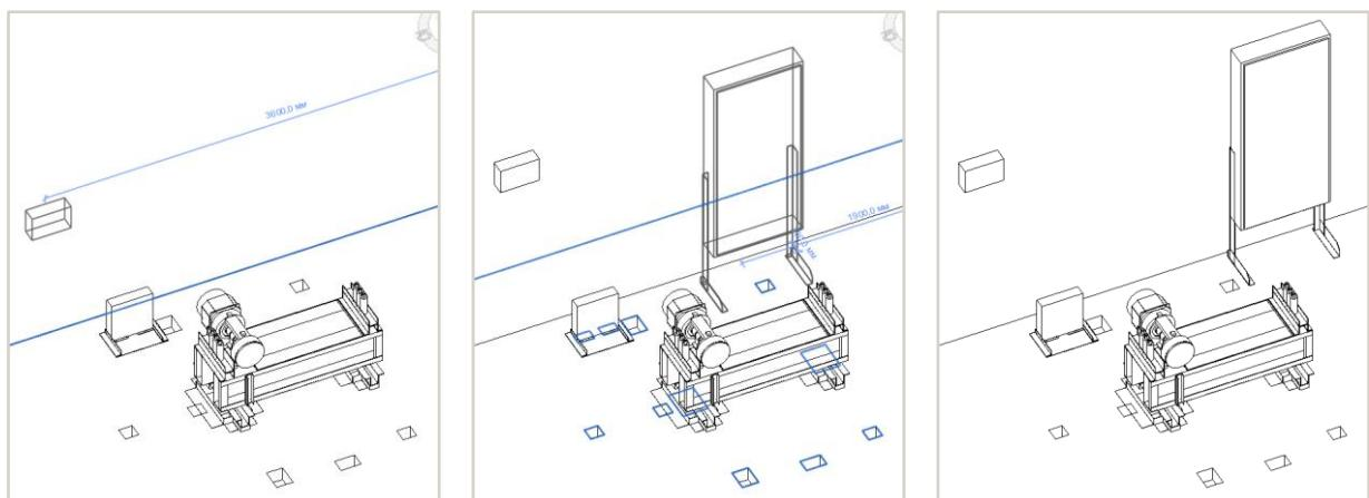
Для входа в машинное помещение должна быть установлена дверь с минимальными размерами в свету (Ш×Г) 800×1800 мм. Дверь должна быть сплошной и не открываться вовнутрь. Семейство двери для доступа в машинное помещение подбирается Проектировщиком.
